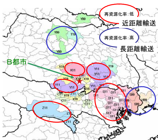
図9 がれき類物流の発生源クラスター (道路網、輸送距離、再資源化率)
