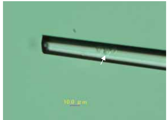
図2-63 PEGによるマイクロピペット内細胞融合 ピペット内で始原生殖細胞と繊維芽細胞が並んでいる
