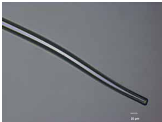
図2-66 作製したガラス製ホールディングピペット 先端は外径が10~20 \mu\text{m} で、長軸に対して直角とする
