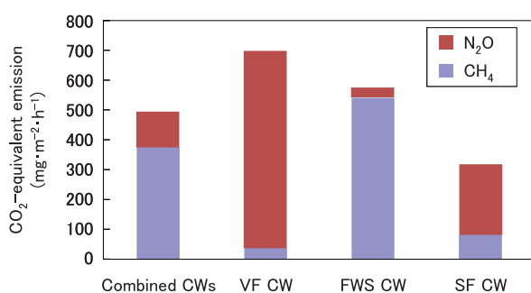
図45 異なる流下方式の人工湿地システムにおける温室効果ガスのフラックスの比較
