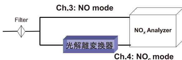
図8 NO<sub>x</sub>計の概略図。
