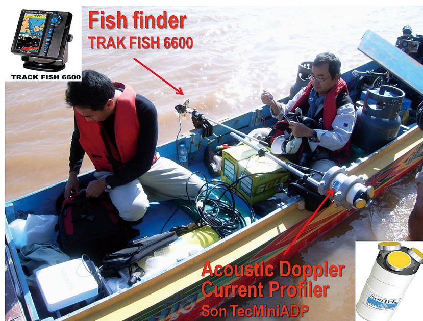
図 65 調査用チャーターボートによるメコン河本流 (北タイ、チェンセン下流部) における現地観測。GPS、ADCP、魚群探知機をセットし、河道内の流速、流化方向、水深、魚類生息状況に関するデータを同時に取得。
