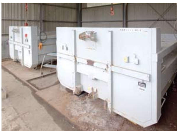
再生処理委託用汚泥保管コンテナ
