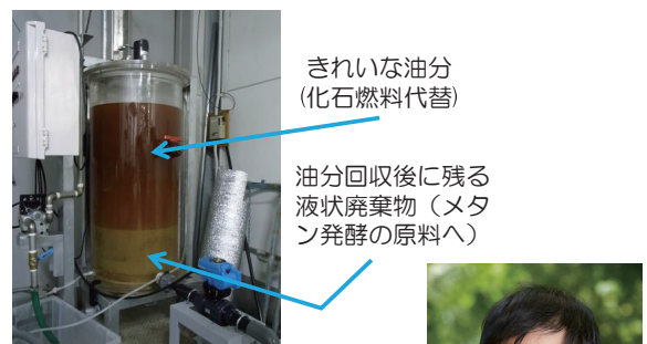
図3 阻集器内油分からきれいな油分を分離する装置
