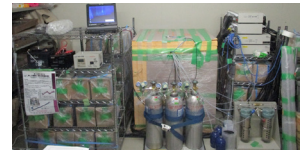
写真2 富士山測候所に設置された省力型の CO 2 濃度観測システム
