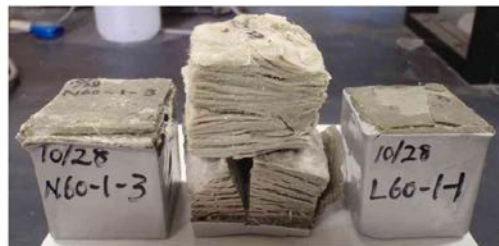
図 7.5.2 コンクリートの劣化現象の例
