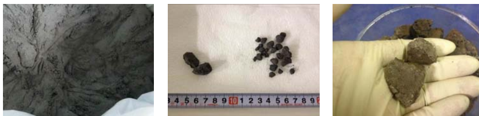
図 8.3 一般廃棄物焼却施設から排出された飛灰の例
