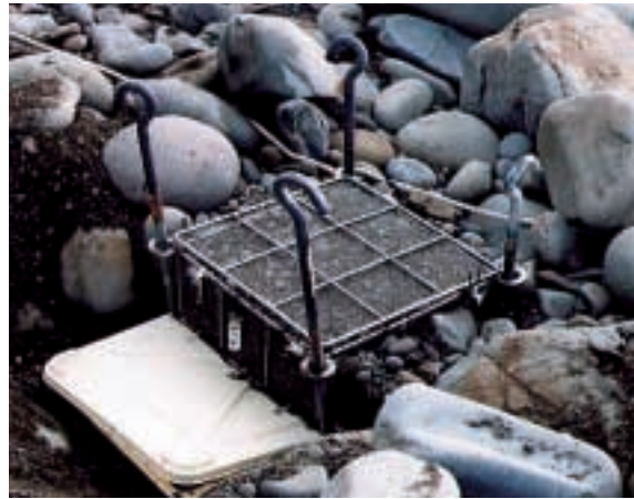
図20 種子島試験現場に埋設した採水用コンテナ付きステンレス網籠
