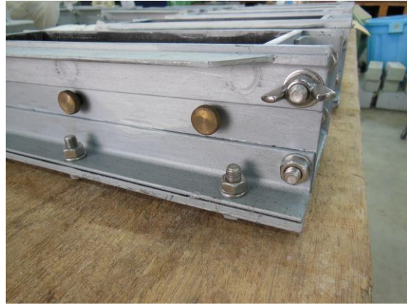
(d) 事例 2 : 側板でのゲージプラグ固定状況
