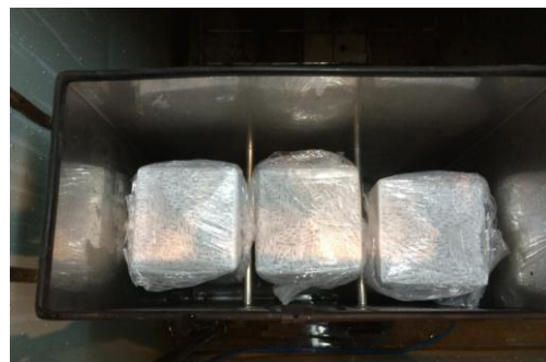
写真-4.3.4 供試体格納容器（左：外観，右上：供試体設置前，右下：供試体設置後）
