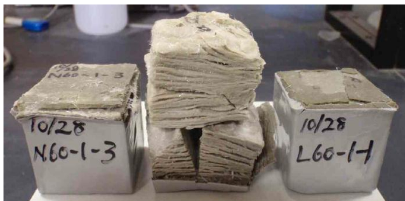
図 2.1 高濃度塩化カルシウムによって劣化したセメントペースト（30mass%、5℃）[2]
