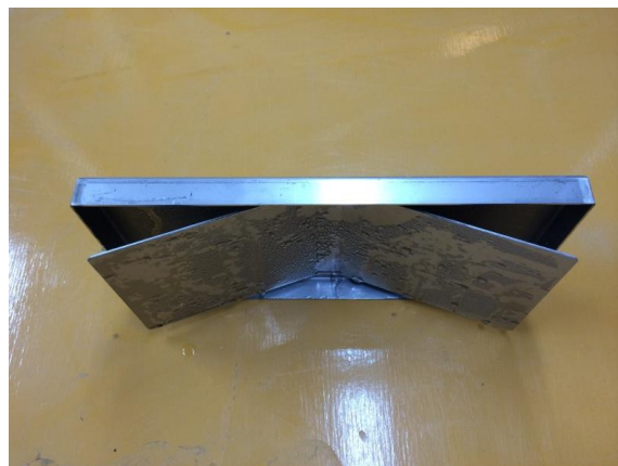
写真-4.3.5 蓋内側の屋根型構造
